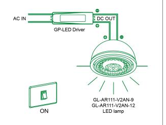
將 GP- LED driver 的輸出端依正(+)負(-)極接上燈具,輸入端接上 AC。
